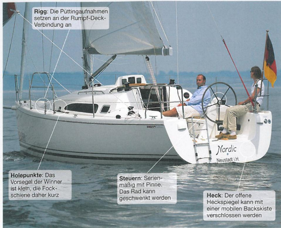
**Rigg:** Die Püttingaufnahmen setzen an der Rumpf-Deck-Verbindung an
