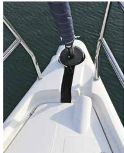
**Die versenkte Rollanlage ermöglicht tief geschnittene Vorsegel, lief im Test aber nicht ganz problemlos.**
