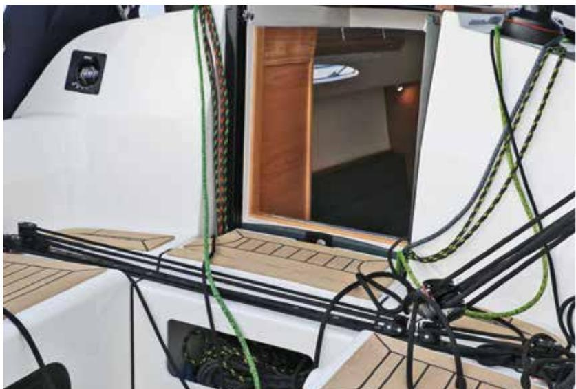
**Niedergang mit Fallenfach im Brückendeck und versenkbaren Steckschotten, ein breiter Traveller mit Leinenverstellung sorgt für effektiven Trimm.**
